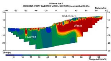
THE LOWER MODEL SHOWS THE IP RESULTS AND WITH THIS ADDITIONAL INFORMATION THE WASTE CAN EASILY BE IDENTIFIED AS ITS CHARGEABILITY IS SIGNIFICANTLY HIGHER THAT THE SURROUNDING SOIL.
